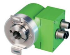
PAME58系列Profibus-DP接口绝对值编码器,采用电子式多圈设计,可满足大量程的信号反馈。产品采用紧凑型通孔结构设计,整体厚度仅70mm,适用于安装空间有限的工位。PAME58产品具备优异的抗机械损伤性能,可承受较高轴向和径向负载,适用于各类工业现场。
