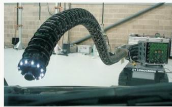
目前，这种机器蛇将在军事和民用航空领域具有巨大应用前景，以及用于核电站放射线区域的安全性检查。该机械手臂受可移动铰链控制，在其末端装配着各种工具，例如：相机、探照灯、切割装置以及刷子等。
